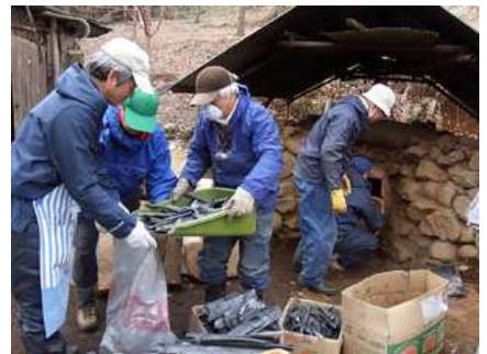
着火後48時間程で消火し、その後3日くらいおいて出炭する。
